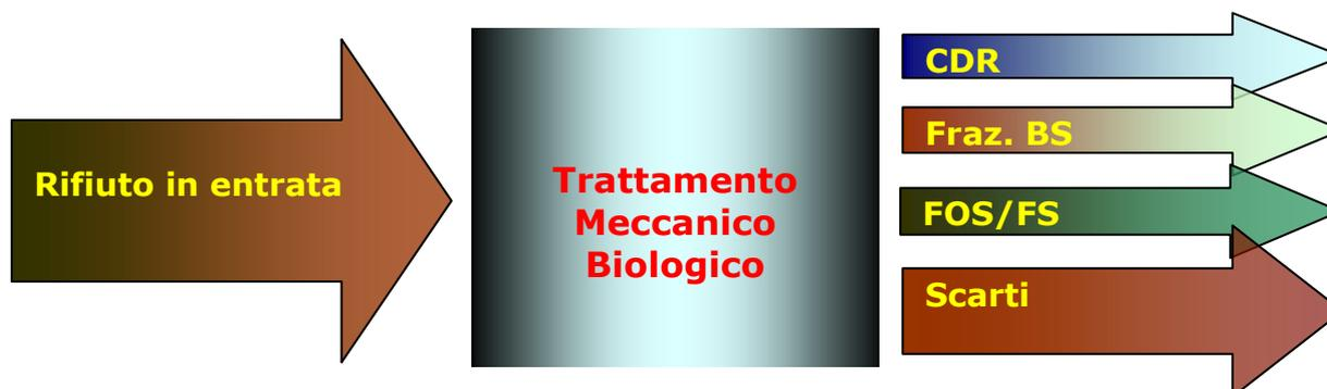
Figura 6.3. Schema concettuale di un impianto di trattamento meccanico biologico
